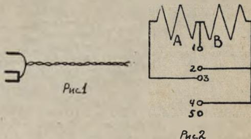
Рис. 2 — Если вилку вставить в гнезда 1, 2, 3, то лампы A и B будут гореть полной яркостью; если же перенести вилку в гнезда 3, 4, 5 — лампы будут гореть в полнакала.
