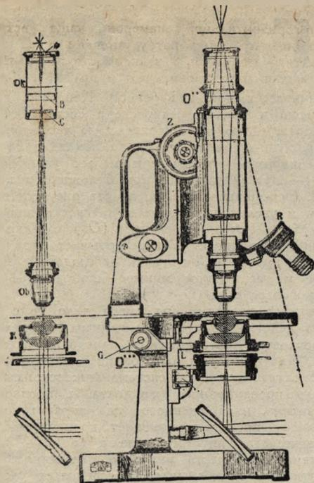
Рис 1. Схема микроскопа
