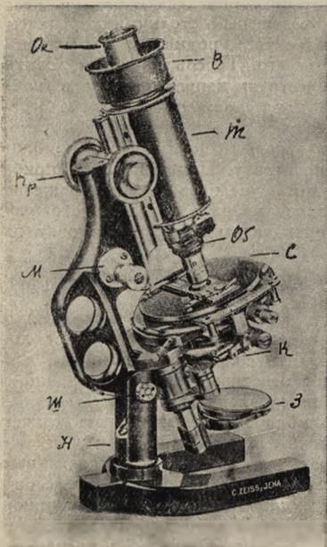
Рис. 2. Микроскоп
