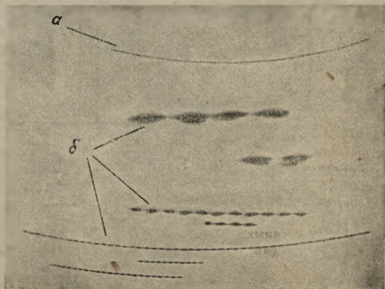
Рис. 1 Следы светящихся точек, полученных: а — при помощи лампочки, б — вольтовой дуги
