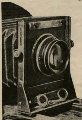
Передвижение объективной доски вверх и вниз и закрепление гайками.
