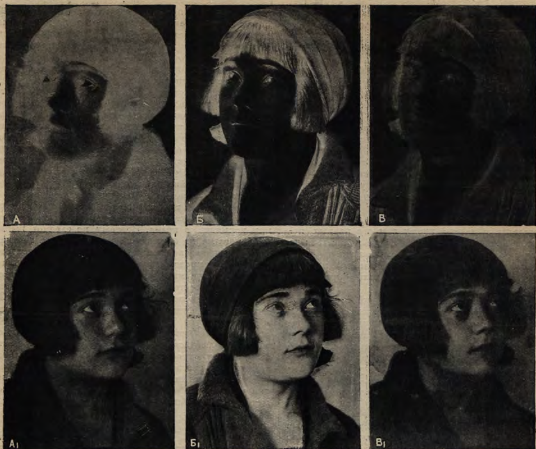
Рис. 5. Зависимость негатива и отпечатка от экспозиции при с'емке.
