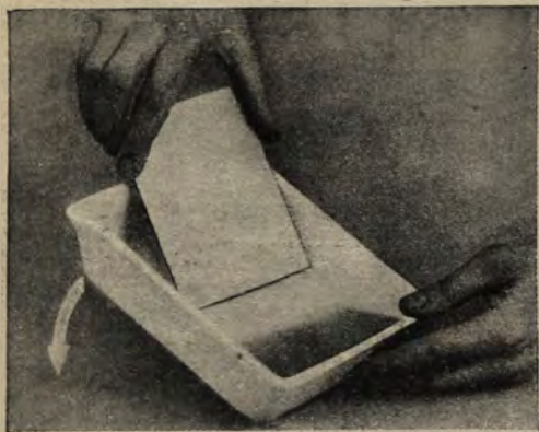
Рис. 3. Как следует опускать пластинку в проявитель.
