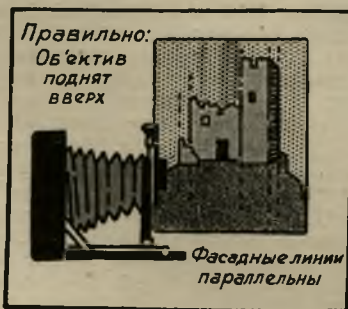
Рис. 3. Положение камеры при с'емке высоких зданий. Камеру нельзя наклонять вверх, так как это поведет к получению неправильного изображения (см. также фото на следующей странице). В случае необходимости следует, оставив самую камеру в строго горизонтальном положении, поднять вверх объективную часть.
