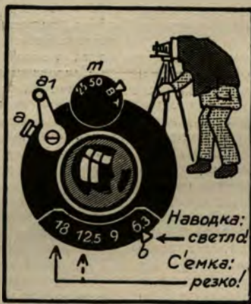
Рис. 1. При установке изображения на резкость по матовому стеклу — пользуются полным отверстием объектива; для с'емки — ставят ту диафрагму, которая соответствует условиям данной с'емки. Обозначения на затворе (неавтоматом): m — диск скоростей затвора, a — отверстие для проволочного спуска, a — рычаг для спуска затвора, b — рычаг для установки диафрагмы.
