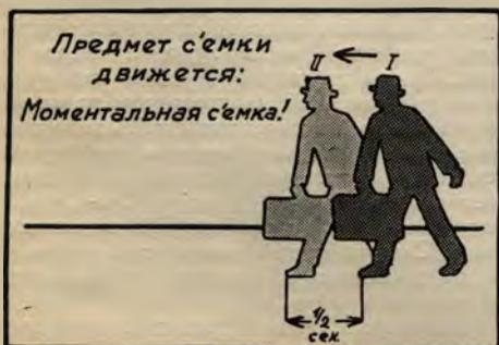
Рис. 7. В течение  $\frac{1}{2}$  секунды идущий человек передвигается из положения I в положение II. Поэтому нельзя, например, внять экспозицию в  $\frac{1}{2}$  сек., так как при ней на пластинке получится размазанное изображение; экспозиция должна быть значительно короче.
