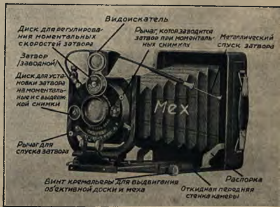
Рис. 8. Важнейшие части клапп-камеры для пластинок.
