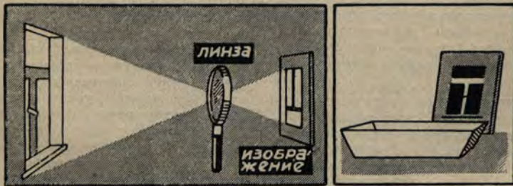
Рис. 1. Основы фотографии: позади выпуклой линзы образуется изображение, которое закрепляется при помощи химических средств.
