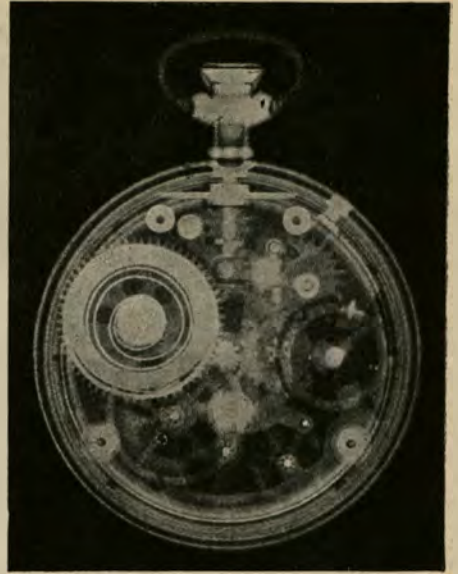
Фот. 3. Рентгеновский снимок часов. Все детали получены при закрытой крышке.
