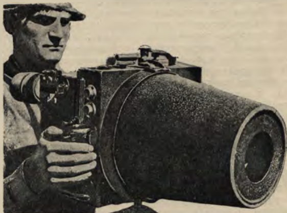
Это—не миномет, а американская военная намера для воздушной фото-съемки, дающая с высоты 4.000 метров отчетливые снимки неприятельских позиций.
