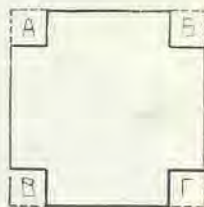
Рис. 3. План доньшка станка. Квадратики А, Б, В и Г выпиливаются и служат местом для ножек.
