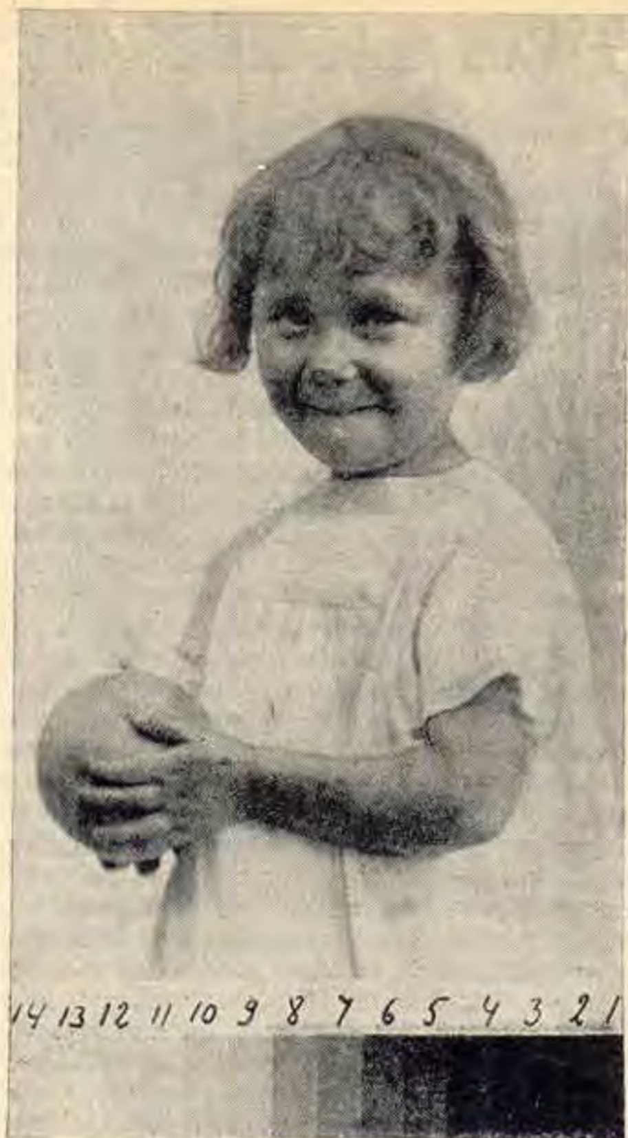
Определение контрастности негатива. 12-ая градация—105, соответствует самому светлому пятну отпечатка (плечо), а 6-ая градация—5, самому темному (тень в волосах). След., контрастность негатива = 7 градациям. В непрозрачных она же: 105 : 5 = 21 .
